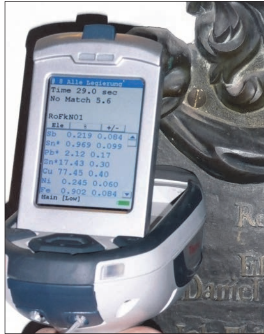
2 | Ein mobiles Röntgenfluoreszenzanalysegerät (RFA) zur Bestimmung der Legierung. Bereits nach wenigen Sekunden kann auf dem Display die Oberflächenzusammensetzung abgelesen werden. Bei dem hier gemessenen Objekt handelt es sich also um eine Legierung mit den Hauptbestandteilen Kupfer Cu (77,5 %), Zink Zn (17,5 %) und Blei Pb (2,1 %).
