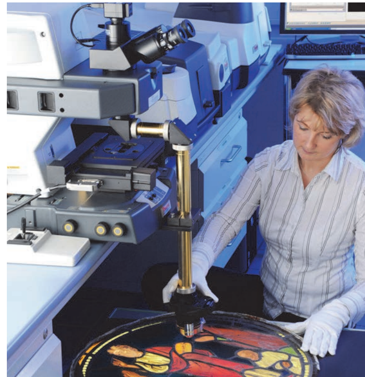
1 | FTIR im Fraunhofer ISC-Kulturgutlabor in Bronnbach mit externem Probenarm zur zerstörungsfreien Analyse von Kunst- und Archivgut. Aufnahme: K. Dobberke für Fraunhofer ISC.
