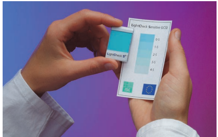
7 | Lichtdosimeter LightCheck® Sensitiv mit Vergleichsskala (Aufnahme: K. Dobberke für Fraunhofer ISC). Durch einen Vergleich der Farbe des Dosimeters mit der Skala kann auf die maximale Belichtungsdauer in Luxstunden im Expositionszeitraum geschlossen werden, siehe Tabelle 3.
