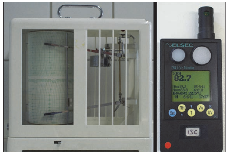
5 | Links ein klassischer Thermohygrograph; rechts ein Datenlogger zur Erfassung der Parameter Temperatur und relativer Luftfeuchte sowie zusätzlich von UV-Strahlung und Lichtintensität in Lux; Foto nicht maßstäblich.
