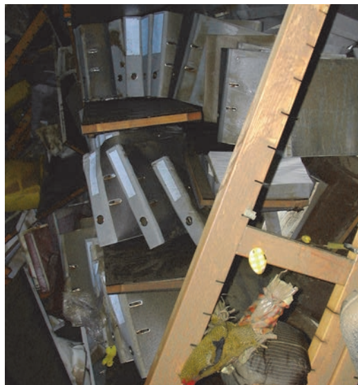
7 | Durch die Last eingestürzte Holzgestelle.
