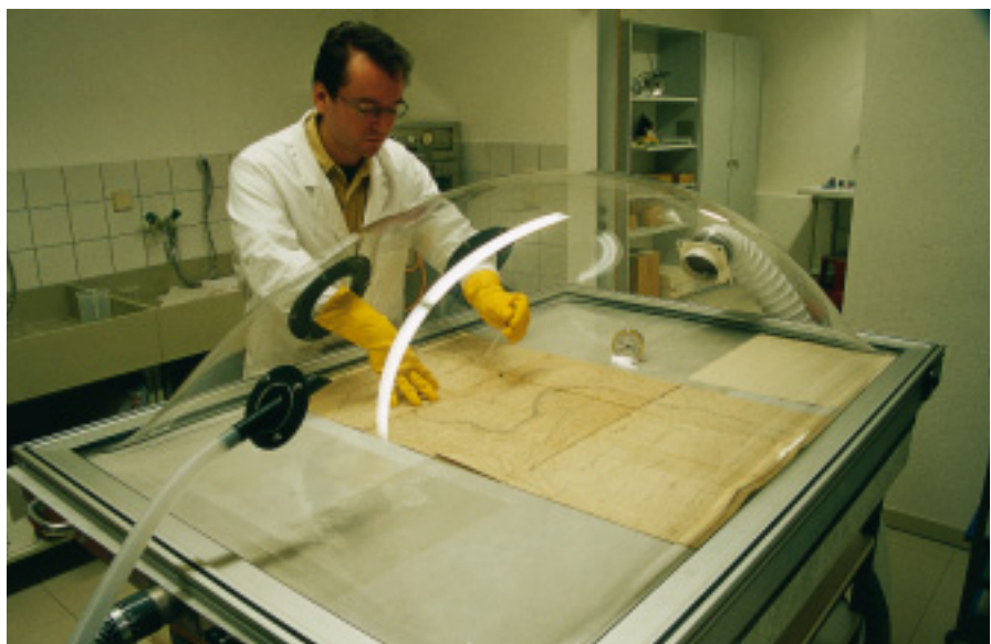
Unter der großen Plexiglashaube des neuen Saugtisches im Staatsarchiv Sigmaringen werden schädliche Falten einer historischen Karte unter hoher Luftfeuchtigkeit weggesaugt.
