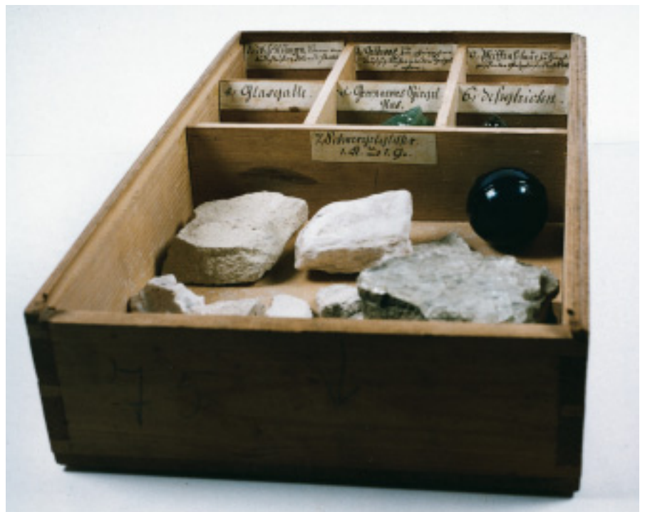
Holzkästchen aus der Spiegelmanufaktur Spiegelberg, unter anderem mit Glasgalle, geronnenem Spiegelglas und blauer Glaskugel, um 1783. Vorlage: Hauptstaatsarchiv Stuttgart
