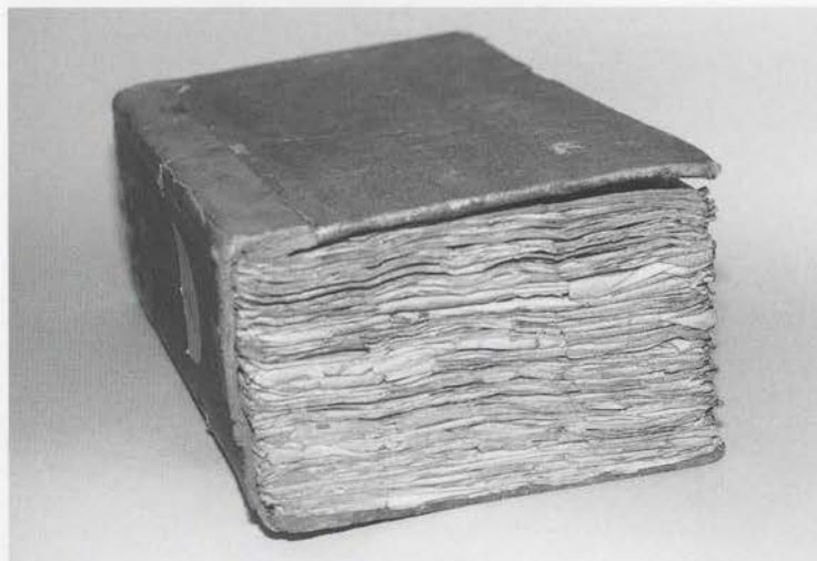
Abb.: 16: Der zu klein geratene Einband schützt den Buchblock nicht. Die „Standschäden“ am Buchblock sind deutlich sichtbar.
